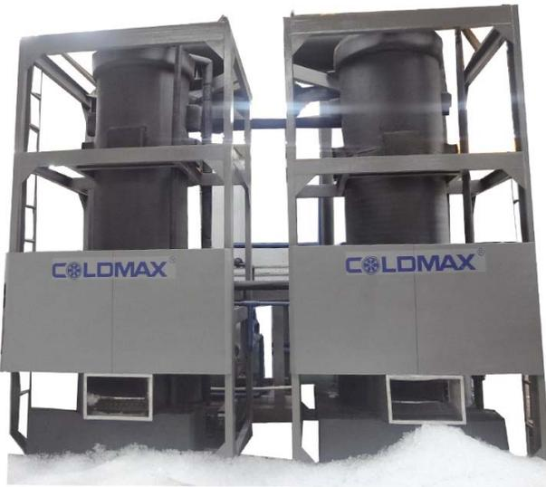
管冰机是一款生产圆柱型食用冰块的制冰机。由多根不锈钢管组成蒸发器，制冷剂在管与管之间流动，水在管内从上往下在分水器的作用下呈螺旋状流动，水在流动过程中凝结成冰。管冰机配备数字压控、机械压控和时间继电器三重保护，严格控制冰块成型速度，防止不锈钢管冻裂，冰块成型后在上述三种控制作用下制冰系统向蒸发器供热，使得冰块自由下落，与此同时与冰刀相切，形成长度 3-5cm 不等的圆柱形冰块，即管冰。由于管冰机占地面积小，换热效率高，节能明显而受到市场青睐。
